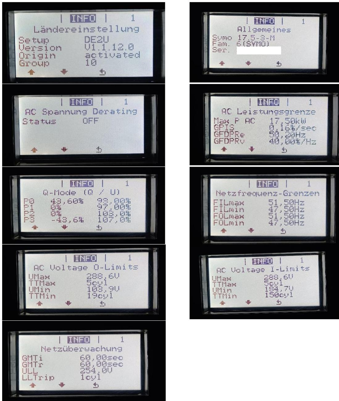
**Achtung:** Eingestellte Parameter nur für Fronius Wechselrichter dieses Typs gültig (aufgrund von Umrechnungsfaktoren im Hintergrund weichen die dargestellten Werte marginal von den offiziell geforderten Entkuppelungsschutzparametern ab).
