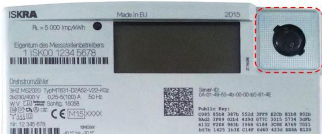
Ihre neue Messeinrichtung ist mit einem sogenannten „optischen Taster“ ausgestattet. Dies ist eine Fotodiode, die einen mechanischen Taster ersetzt. So kann die Messeinrichtung auch bedient werden, wenn diese zum Beispiel hinter Glas ist. Der optische Taster funktioniert beispielsweise durch den Lichtimpuls einer Taschenlampe.
