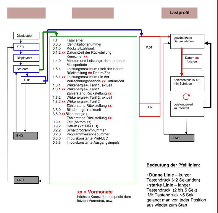
Bei Zählern für Wandleranschluss (in der Typenkennzeichnung ist ein "W" enthalten) sind die Ablesewerte mit der Wandlerübersetzung zu multiplizieren.
