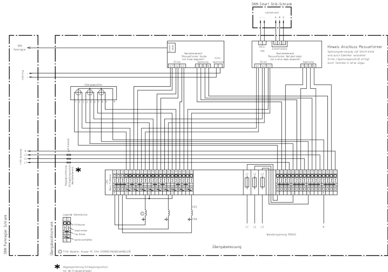
Abbildung 3: Klemmleiste Übergabemessung (MS) Stand: April 2024
